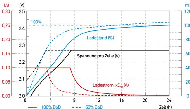
Ladung mit konstanter Spannung 2,40 V pro Zelle bei 20 °C und begrenztem Strom 0,2 C<sub>10</sub> A
